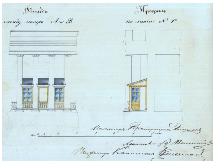
Рис. 10. Фасад и вид сбоку на деревянный тамбур [16]
