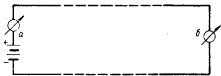
Рис. 33. Схема для измерения потерь в линии.
